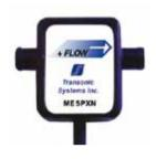
チューブ用プローブは摘出した灌流組織研究のような体外循環における流量測定に使用されます。インラインフローセンサーは簡単に実験チューブとつなぎ、キャリブレーションでき、水、生理食塩水、バッファー、血液のような液体の流量測定ができます。トランスジューサは1 mL/min ~ 100 L/minまでのレンジのフローに対し、非常に高い精度を持っています。滅菌されたチューブフローセンサー (PXL) は、実験チューブの外側に取り付けることにより、生理食塩水、バッファー、血液、水、その他の有機溶液のような多くの通気されていない溶液の計測に使用できます。このとき溶液に対して物理的な接触は一切ありません。フローセンサーは最大で4つの異なる液体/温度/チュービングの組み合わせに対してキャリブレーション、プログラムすることが可能であり、センサーは外径3~32 mmのチューブに対して使用することができます。
