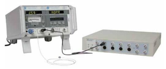
ADInstrumentsのPowerLabデータ記録システムとTransonic Systemsの血流計を組み合わせることで, in vivo, in vitroにおいて正確に血流の記録,表示,解析を行うことができます。
